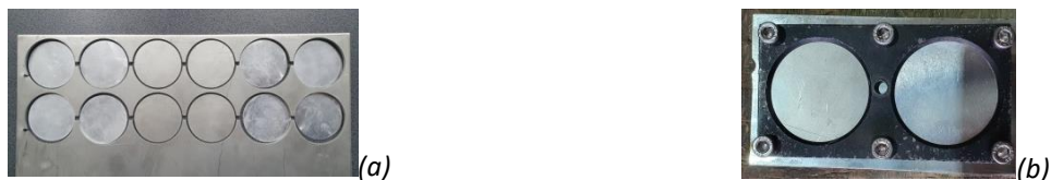
Figura.1 (a) Debitarea substraturilor din diferite materiale prin jet de apă; (b) Confecționarea suportilor speciali (exemplu suport folosit la depunerile AP-plasma);
