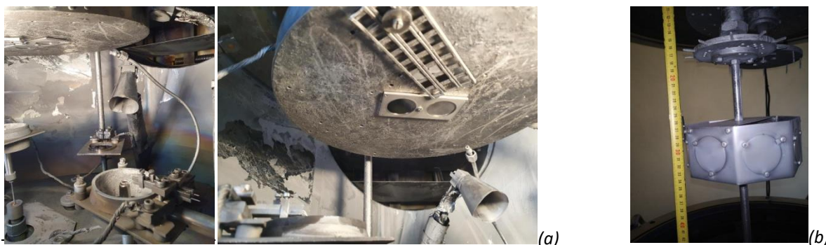
Figura 2(a) Imagine interior din incinta de depunere a instalației TVA cu suport montat cu substraturi (pre-depunere); (b) Imagine instalație CMSII cu substraturi montate (post-depunere);
